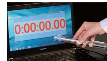
動作中のノートPCのキーボード部に30ccの水を注ぎ、データを保存するまでの一定時間、電源ショートが起きないことを確認しました。
