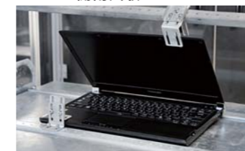
ディスプレイの開閉を連続的に実施し、PCのヒンジへの影響を確認します。
