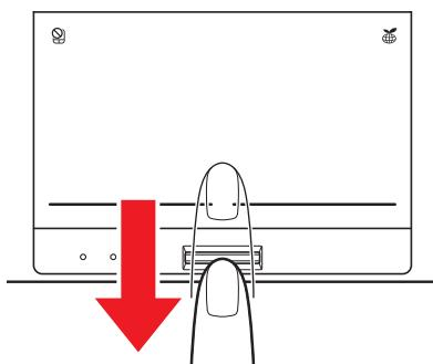
同じ指を3回認識させてください。指紋センサーに指をすべらせると、画面の3つのボックスに、1回ごとの指紋データの読み取り結果が表示されます。
