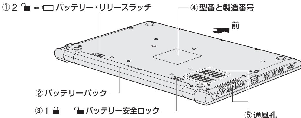
本製品はバッテリーパック搭載モデル（バッテリーパックをお客様ご自身で交換できるモデル）です。バッテリーパックを取り付けた状態で使用してください。
