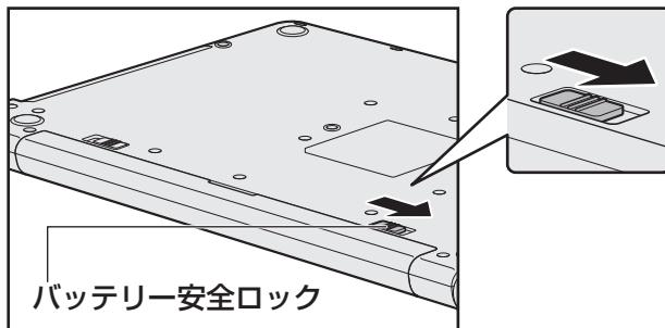
**5** バッテリー・リリースラッチを矢印の方向にスライドしながら①、バッテリーパックを取りはずす②
