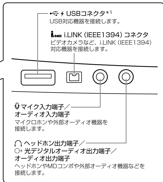
\*1 設定を行うと、パソコン本体の電源が入っていない状態でも、USBコネクタから外部機器に電源を供給することができます。
