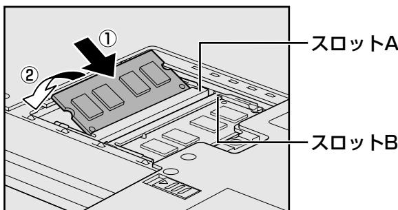
増設メモリの切れ込みを、メモリスロットのコネクタのツメに合わせて、しっかりと差し込みます。
