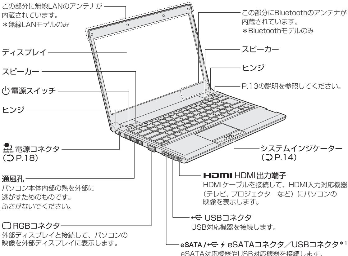
\* 1 設定を行うと、パソコン本体の電源が入っていない状態でも、USBコネクタから外部機器に電源を供給することができます。
