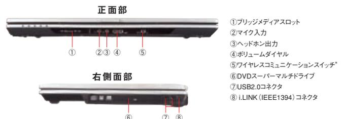
\*電波を発してはいけない場所などで使用する際に、無線通信機能の電波の発信を停止するスイッチです。
