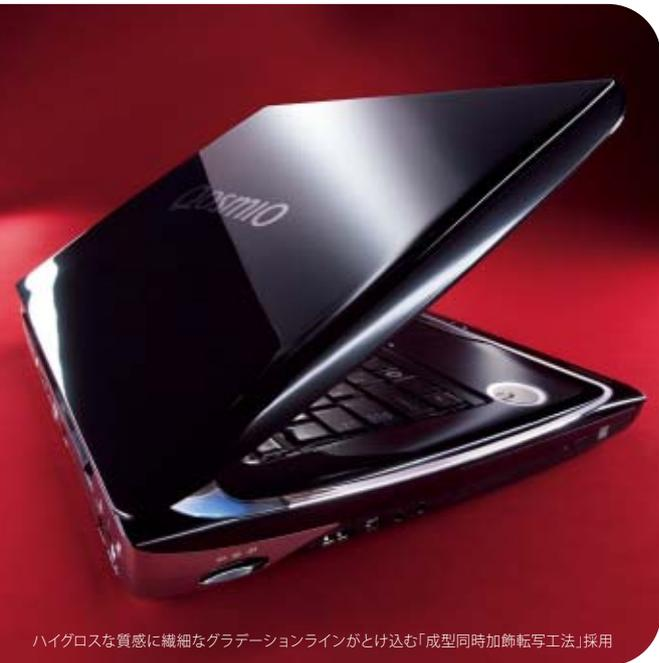
ハイグロスな質感に繊細なグラデーションラインがとけ込む「成型同時加飾転写工法」採用
