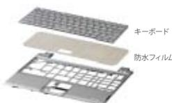
**100kgf面加圧、75cm落下、100cc浸水のTÜV試験をクリア**
