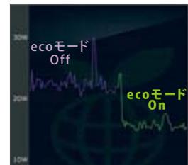
消費電力の推移をリアルタイム表示。On/Offの切り替え時の変化も視覚的に確認できます。
