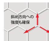
ハニカム形状のリブが応力を分散し、強度をアップ。
