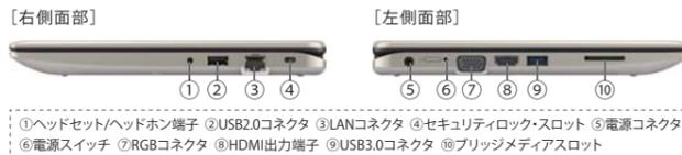
①ヘッドセット/ヘッドホン端子 ②USB2.0コネクタ ③LANコネクタ ④セキュリティロック・スロット ⑤電源コネクタ ⑥電源スイッチ ⑦RGBコネクタ ⑧HDMI出力端子 ⑨USB3.0コネクタ ⑩ブリッジメディアスロット
