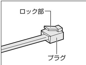
モジュラーケーブルをはずしたり差し込むときは、モジュラープラグの部分を持って行ってください。また、はずすときは、ジャックプラグのロック部分を押しながらずしてください。ケーブルを引っ張らないでください。
