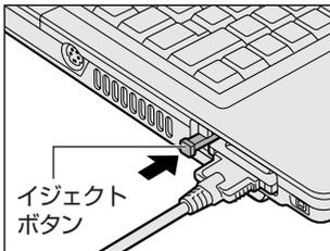
1回押すとイジェクトボタンが出てくるので、もう1度「カチッ」と音がするまで押してください。カードが少し出てきます。
