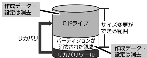
① [C: ドライブのサイズ] で ▲ ▼ をクリックしてパーティション（Cドライブ）のサイズを指定する
