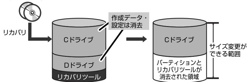
① [C : ドライブのサイズ] で ▲ ▼ をクリックしてパーティション（C ドライブ）のサイズを指定する
