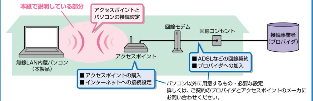
本紙では、WPSプッシュボタン方式(WPSとよびます)対応のアクセスポイントとパソコンを無線LANで接続する手順を説明します。WPSに対応していない場合の接続設定方法は、「(パソコンで見るマニュアル)」(※参照)をご覧ください。
