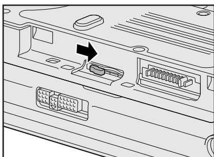
上の図のようにminiB-CASカードがスロットの一番奥まで差し込まれていることを確認してください。正しくカードが差し込まれていないと、地上デジタル放送を受信できません。また、バッテリーパックを取り付ける際に、miniB-CASカードが破損するおそれがあります。
