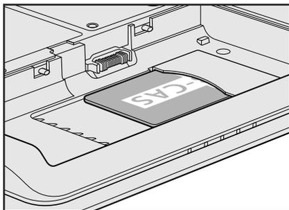
上の図のようにB-CASカードがスロットの一番奥まで差し込まれていることを確認してください。正しくカードが差し込まれていないと、地上デジタル放送を受信できません。また、バッテリーパックを取り付ける際に、B-CASカードが破損するおそれがあります。
