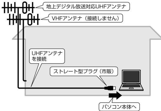
地上デジタル放送を視聴するために、地上デジタル放送対応のUHFアンテナを接続してください。
