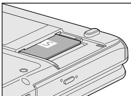
上の図のようにB-CASカードがスロットの一番奥まで差し込まれていることを確認してください。正しくカードが差し込まれていないと、地上デジタル放送を受信できません。また、B-CASカードスロットカバーを取り付ける際に、B-CASカードが破損するおそれがあります。
