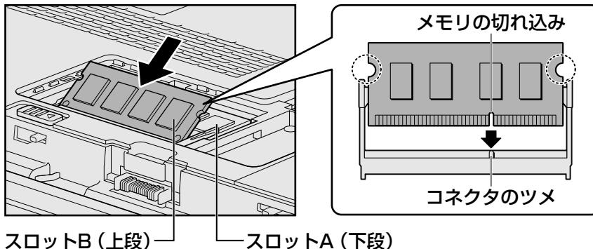
メモリの切れ込みを、メモリスロットのコネクタのツメに合わせて、しっかりと差し込みます。
