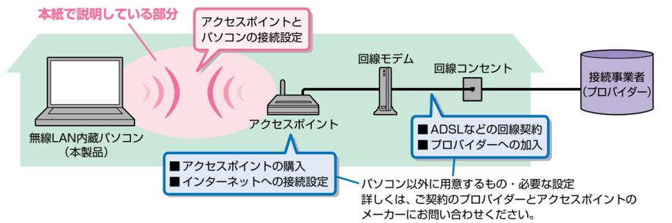
本紙では、WPSプッシュボタン方式（WPSとよびます）対応のアクセスポイントとパソコンを無線LANで接続する手順を説明します。WPSに対応していない場合の接続設定方法は、（パソコンで見るマニュアル）（※参照）をご覧ください。
