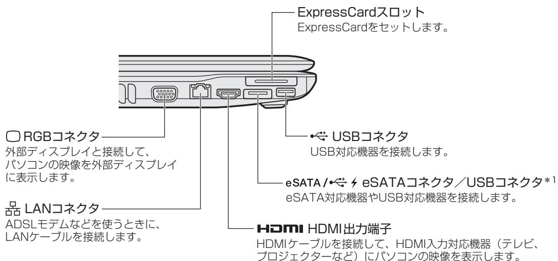
\* 1 設定を行うと、パソコン本体の電源が入っていない状態でも、USBコネクタから外部機器に電源を供給することができます。
