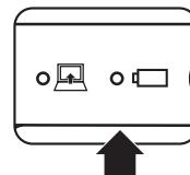
キーボードドックのセカンドバッテリーを充電するときは、キーボードドックの電源コネクタを使用してください。
