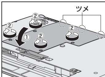
メモリカバーは左図○で囲んだ部分にあるツメを本体のくぼみに合わせてから閉じてください。
