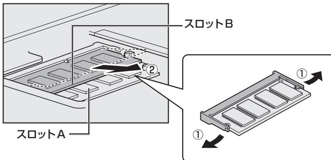
パソコンの裏面を表にした状態で、下段がスロットA、上段がスロットBです。斜めに持ち上がったメモリを引き抜きます。
