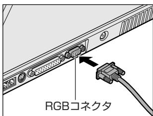
CRT ディスプレイを接続してパソコン本体の電源を入れると、本体は自動的にその CRT ディスプレイを認識します。
