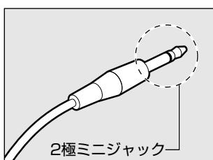
3.5mm  $\phi$  2 極ミニジャックタイプのマイクロホンでもマイクロホン本体にバッテリなどを内蔵し、電源供給を必要としないマイクロホンであれば使用できます。
