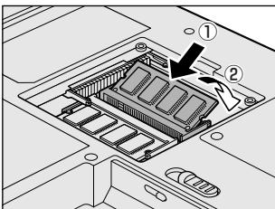
増設メモリの切れ込みを、増設メモリスロットのコネクタのツメに合わせて、しっかりと差し込みます。フックがかかりにくいときは、ペン先などで広げてください。このとき、増設メモリの両端（切れ込みが入っている部分）を持って差し込むようにしてください。
