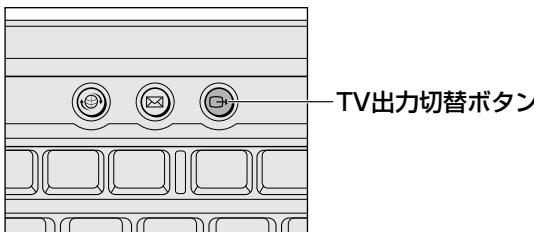
もう一度TV出力切替ボタンを押すと、内部液晶ディスプレイに表示が切り替わります。
