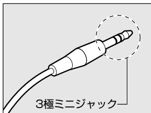
プラグは 3.5mm  $\phi$  3 極ミニジャックタイプが使用できます。
