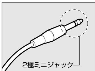
3.5mm φ 2極ミニジャックタイプのマイクロホンでもマイクロホン本体にバッテリーなどを内蔵し、電源供給を必要としないマイクロホンであれば使用できます。
