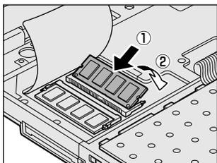
増設メモリの切れ込みを、増設メモリスロットのコネクタのツメに合わせて、しっかり差し込みます。フックがかりにくいときは、ペン先などで広げてください。
