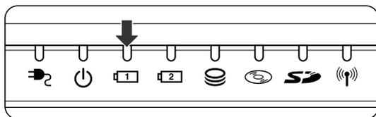
バッテリー駆動で使用しているときにオレンジ色に点滅した場合は、バッテリーの充電が必要です。Battery LEDは次の状態を示しています。
