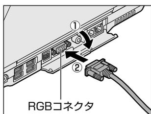
CRT ディスプレイを接続してパソコン本体の電源を入れると、本体は自動的にその CRT ディスプレイを認識します。
