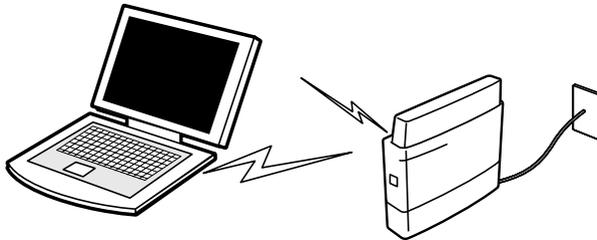
また、Bluetooth 機能機器同士でネットワークを組むこともできます。その場合、ネットワークの中心となる Bluetooth 対応機器 1 台（マスタデバイス）と、それに応答する Bluetooth 対応機器 7 台（スレーブデバイス）で最大で 8 台の構成になります。2 つ以上のネットワークに同時に参加することもできます。
