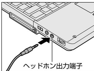
取りはずすときは、ヘッドホン出力端子からヘッドホンのプラグを引き抜きます。
