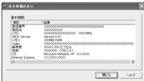
表示される内容は、「東芝 PC 診断ツール」を起動した時点での設定内容です。設定を変更した場合は、「東芝 PC 診断ツール」を起動しなおすと変更後の設定内容が表示されます。ただし、[CPU] の項目には、搭載されている CPU の最大クロック数（固定値）が表示され、これはユーティリティなどによる設定値には影響されません。
