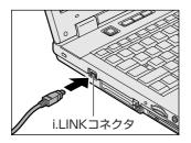
2 ケーブルのもう一方のプラグを i.LINK 対応機器に差し込む
