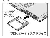
「カチッ」と音がするまで挿入します。正 しくセットされるとイジェクトボタンが出 てきます。
