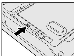
バッテリパックがはずれないように、バッテリ安全ロックは必ず行ってください。
