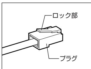
LAN ケーブルをはずしたり差し込むときは、プラグの部分を持って行ってください。また、はずすときは、プラグのロック部を押しながらはずしてください。ケーブルを引っ張らないでください。
