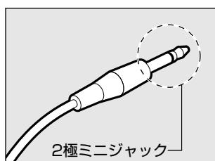
3.5mm φ 2極ミニジャックタイプのマイクロホンでもマイクロホン本体にバッテリなどを内蔵し、電源供給を必要としないマイクロホンであれば使用できます。
