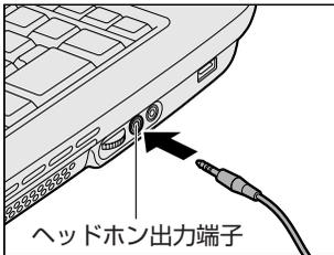
取りはずすときは、ヘッドホン出力端子からヘッドホンのプラグを抜きます。
