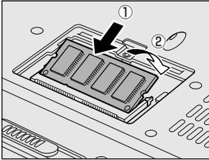
増設メモリの切れ込みを、増設メモリスロットのコネクタのツメに合わせて、しっかり差し込みます。フックがかかりにくいときは、ペン先などで広げてください。このとき、増設メモリの両端（切れ込みが入っている部分）を持って差し込むようにしてください。
