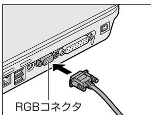
外部ディスプレイを接続してパソコン本体の電源を入れると、本体は自動的にその外部ディスプレイを認識します。
