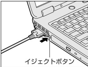
1回押すとイジェクトボタンが出てくるので、もう1度力チツと音がするまで押してください。ダミーカードが出てきます。
