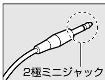
3.5mm φ 2極ミニジャックタイプのマイクロホンでもマイクロホン本体にバッテリーなどを内蔵し、電源供給を必要としないマイクロホンであれば使用できます。
