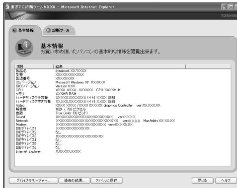
表示される内容は、「東芝PC診断ツール」を起動した時点での設定内容です。設定を変更した場合は、パソコン本体を起動しなおすと変更後の設定内容が表示されます。ただし、[CPU] の項目には、搭載されているCPUの最大クロック数（固定値）が表示され、これはユーティリティなどによる設定値には影響されません。
