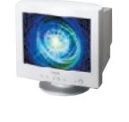
15型ブラウン管、低反射帯電防止処理 最大表示解像度:1,280×1,024ドット 外形寸法:360mm (W)×382mm (D)×370mm (H) アナログRGB接続 質量:約12.5kg
