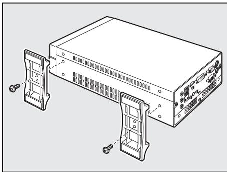
**3** はずしたネジを元のネジ穴に取り付ける
