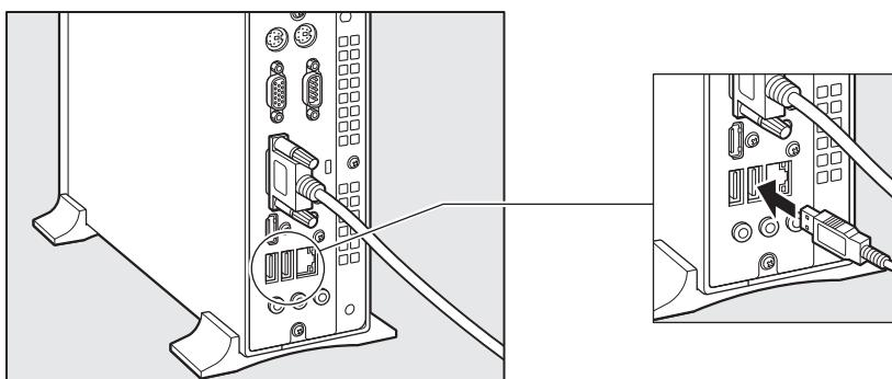
\* 上のイラストは一例として、本体背面のUSBコネクタを載せています。本体正面のUSBコネクタに接続することもできます。
