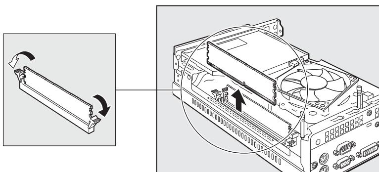
**8 増設メモリを真上に引き抜く**
