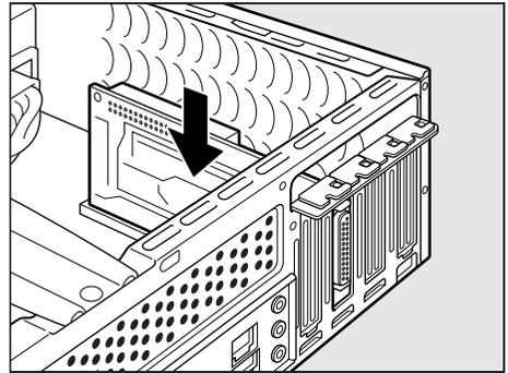
**!** 注意 ・PCIカードには鋭い突起があります。取り付け作業時には、指を傷つけないように作業用手袋を使用してください。
