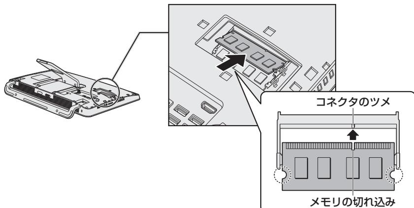
メモリの切れ込みを、メモリスロットのコネクタのツメに合わせて、しっかりと差し込みます。このとき、メモリの両端（上図○で囲んだ部分）を持って差し込むようにしてください。
