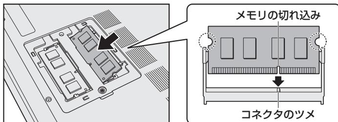
メモリの切れ込みを、メモリスロットのコネクタのツメに合わせて、しっかり差し込みます。このとき、メモリの両端（上図○で囲んだ部分）を持って差し込むようにしてください。
