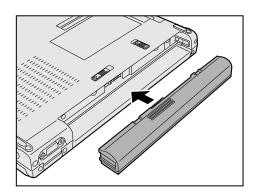
⚠️ 注 意 ・バッテリパックがしっかりと取り付けられているかどうか、必ず確認してください。 正しく取り付けられていないと、持ち運ぶときにバッテリパックがはずれ落ちて、思 わぬケガのおそれがあります。
