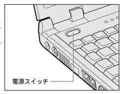
初めて電源を入れた場合は、[Windows セットアップの確認]の画面が表示されます。 表示されるメッセージに従って、Windows のセットアップを行なってください。 ☞ セットアップの方法 ⇨「本章 2 初めて電源を入れるとき」
