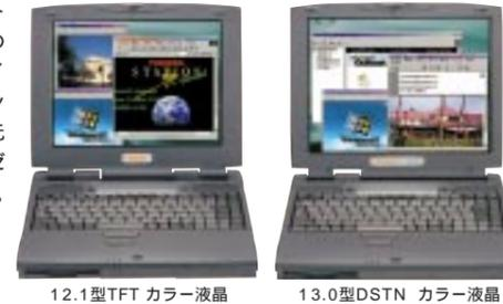
12.1型TFT カラー液晶 13.0型DSTN カラー液晶
