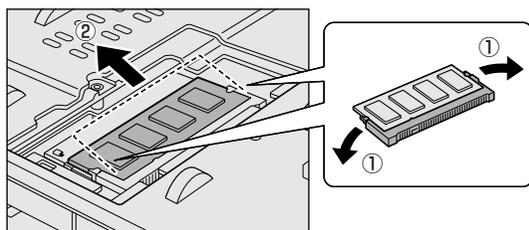
パソコンの裏面を表にした状態で、下段がスロット A、上段がスロット B です。
