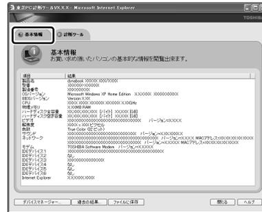
表示される内容は、「東芝 PC 診断ツール」を起動した時点での設定内容です。設定を変更した場合は、パソコン本体を起動しなおすと変更後の設定内容が表示されます。ただし、[CPU] の項目には、搭載されている CPU の最大クロック数 (固定値) が表示され、これはユーティリティなどによる設定値には影響されません。
