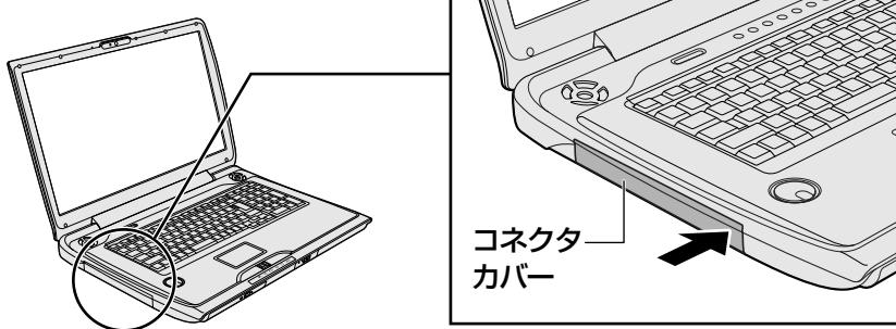
**3** USBケーブルのもう一方のプラグをパソコン本体のUSBコネクタに差し込む
