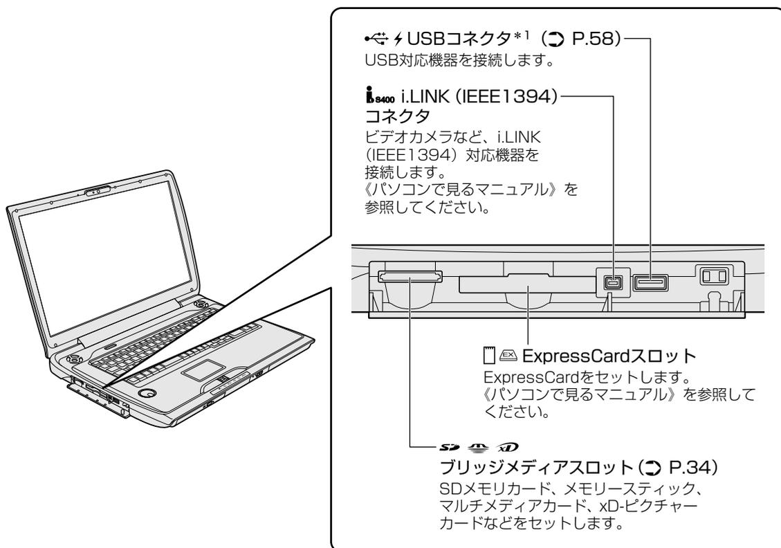
\*1 設定を行うと、パソコン本体の電源が入っていない状態でも、USBコネクタから外部機器に電源を供給することができます。
