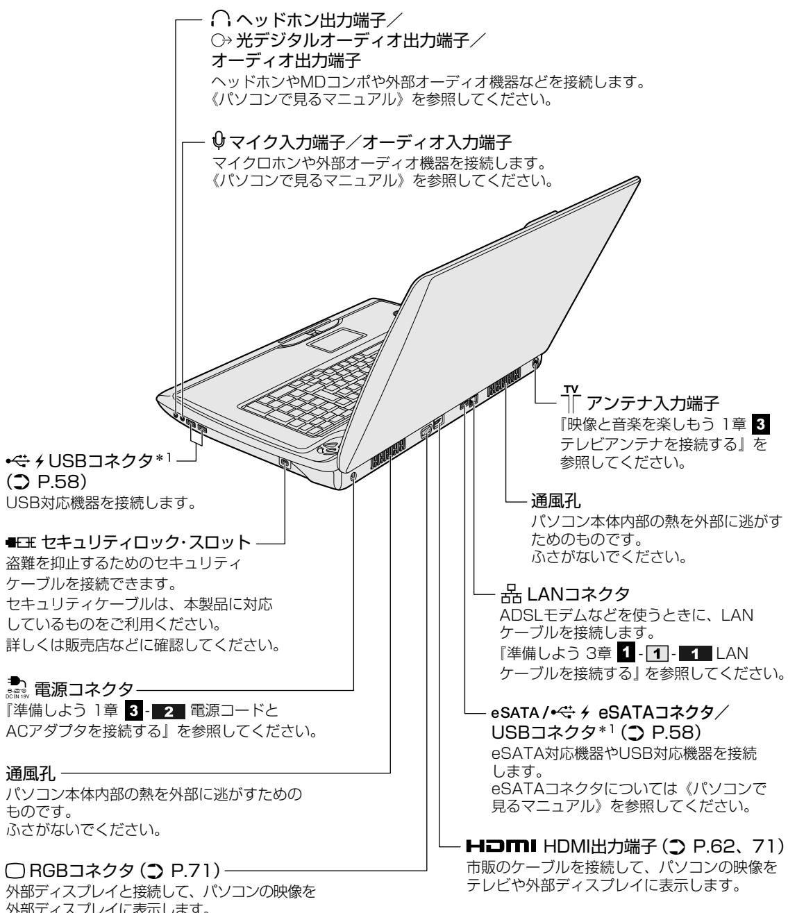
\*1 設定を行うと、パソコン本体の電源が入っていない状態でも、USBコネクタから外部機器に電源を供給することができます。
