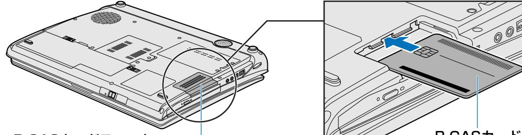
B-CASカードに印刷されているバーコードが見えるように「B-CAS」のロゴを下にしてから、金メッキ端子部を先頭にしてセットしてください。
