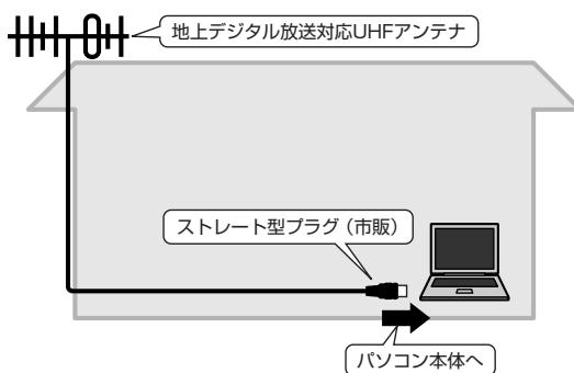
アンテナ線の先端に市販のストレート型プラグを取り付け、接続します。
