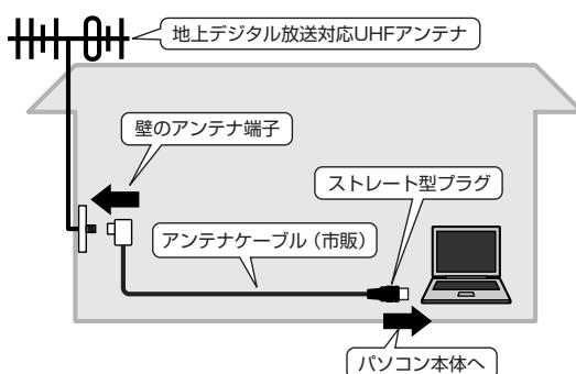
マンションなどで壁面にアンテナ端子だけがある場合は、市販のアンテナケーブルをお買い求めください。
