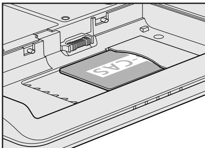
上の図のようにB-CASカードがスロットの一番奥まで差し込まれていることを確認してください。正しくカードが差し込まれないと、地上デジタル放送を受信できません。また、バッテリーパックを取り付ける際に、B-CASカードが破損するおそれがあります。
