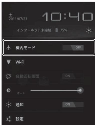
[機内モード] をOFFにすると無線通信機能がONになります。インジケータをWi-Fiモードに設定している場合、無線LAN機能がONに切り替わると点灯します。
