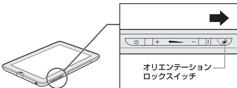
オリエンテーションロックスイッチの左側に赤い線が見えている状態のとき、画面の向きは固定されています。
