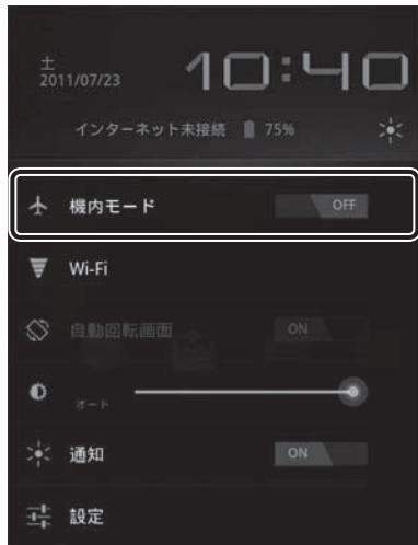
[機内モード] をOFFにすると無線通信機能がONになります。インジケーターをWi-Fiモードに設定している場合、無線LAN機能がONに切り替わると点灯します。
