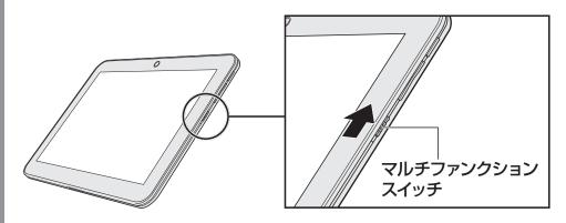
マルチファンクションスイッチの手前側(音量ボタンとは逆側)に赤い線が見えている状態のとき、画面の向きは固定されています。
