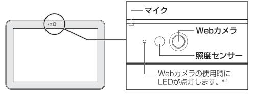
\* 1 前面のWebカメラを使用するとき のみ点灯します。
