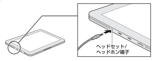
取りはずすときは、ヘッドセット/ヘッドホン端子からヘッドホンのプラグを抜きます。
