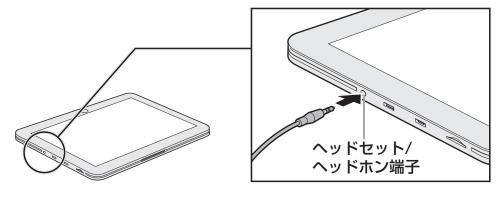
取りはずすときは、ヘッドセット/ヘッドホン端子からヘッドセットのプラグを抜き ます。
