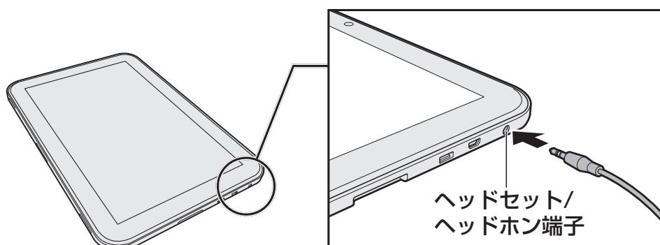
取りはずすときは、ヘッドセット/ヘッドホン端子からヘッドホンのプラグを抜きます。
