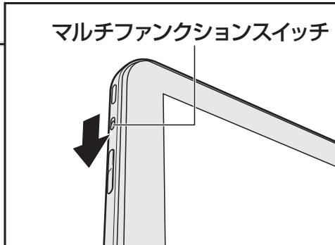
マルチファンクションスイッチの上側（音量ボタンとは逆側）に赤い丸が見えている状態のとき、画面の向きは固定されています。
