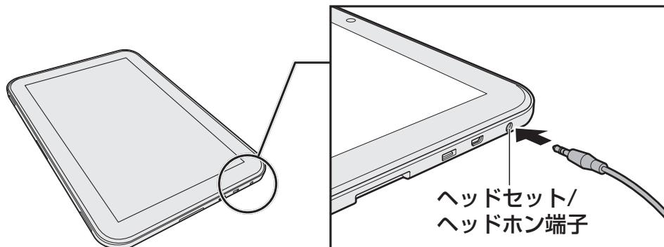
取りはずすときは、ヘッドセット/ヘッドホン端子からヘッドセットのプラグを抜きます。
