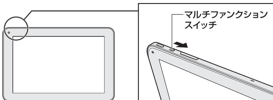
マルチファンクションスイッチの電源スイッチ側に赤い丸が見えている状態のとき、画面の向きは固定されています。
