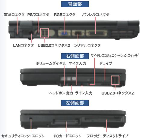
\*電波を発してはいけない場所などで使用する際に、無線通信機能の電波の発信を停止するスイッチです。J40 200L/5Xモデル、J40 200L/5モデルには標準搭載。
