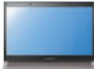
高精細表示HD対応 (1,366ドット×768ドット) の13.3型ワイドTFT液晶による大きくて見やすい画面。さらに、インバーター部が不要なLEDバックライトの搭載により、明るさは従来のままで、低消費電力を実現します。また、水銀フリーで環境負荷低減にも貢献します。
