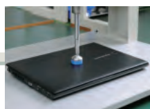
一点加圧試験
