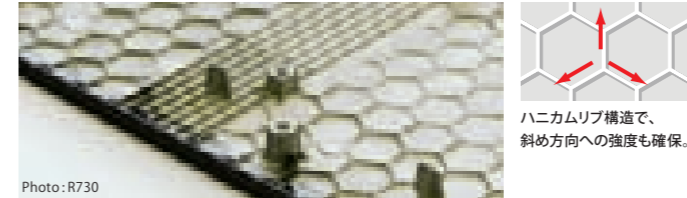
Photo: R730 実装物や必要強度に合わせて、リブの高さや構造を緻密に設計。筐体の耐久性を確保しつつ、ムダを極力そぎ落とすことにより軽量化やスリム化にも貢献。
