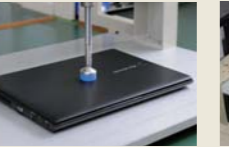
一点加圧試験
