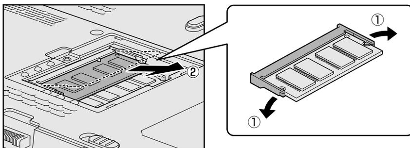
パソコンの裏面を表にした状態で、下段がスロットA、上段がスロットBです。
