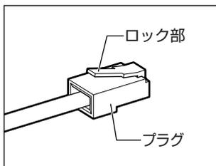
LAN ケーブルをはずしたり差し込むときは、プラグの部分を持って行ってください。また、はずすときは、プラグのロック部を押しながらはずしてください。ケーブルを引っ張らないでください。
