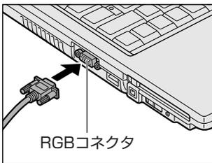
外部ディスプレイの電源を入れてから、パソコン本体の電源を入れます。外部ディスプレイを接続してパソコン本体の電源を入れると、本体は自動的にその外部ディスプレイを認識します。
