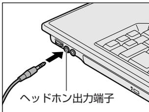
取りはずすときは、ヘッドホン出力端子からヘッドホンのプラグを抜きます。
