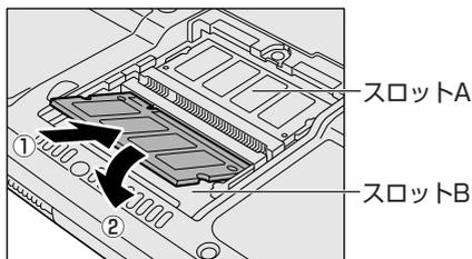
増設メモリの切れ込みを、増設メモリスロットのコネクタのツメに合わせて、しっかり差し込みます。フックがかかりにくいときは、ペン先などで広げてください。
